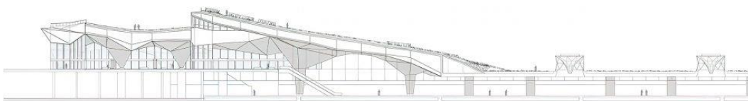
Imagen 4: Sección longitudinal de la estación de tren
